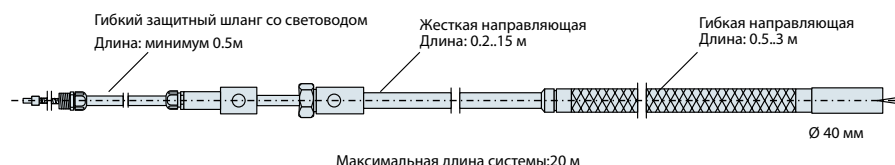
D-LL 701: оптоволоконная система с гибкой направляющей для датчика пламени D-LE 701
